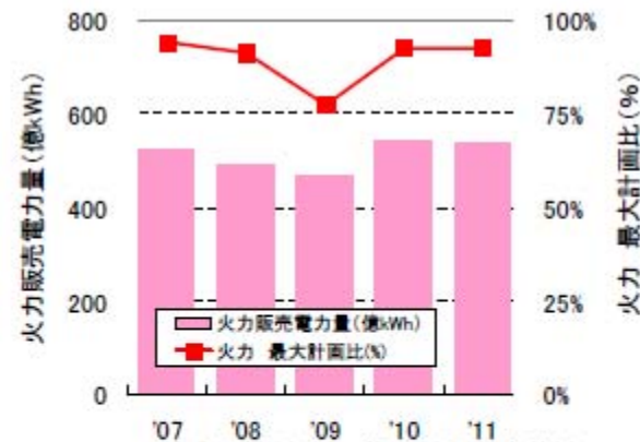
●石炭火力発電所はほぼ設備上限で高稼働
