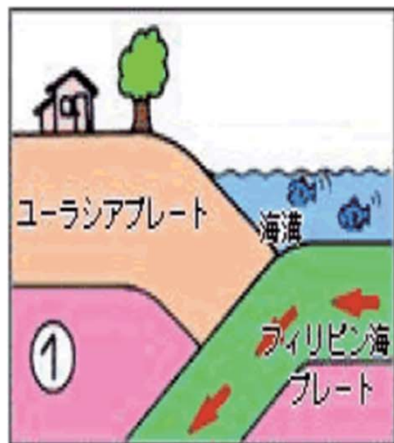
図2-3-3 海溝型地震の発生メカニズム
