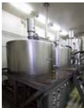
粉碎麦と仕込水（天然水）を混ぜ合わせると、デンプンが糖分に変化。これを濾過しホップを加え煮沸すると麦汁ができる。
